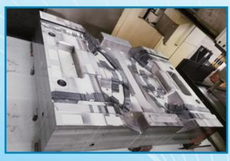
根據客戶的要求進行切削型框及精孔
