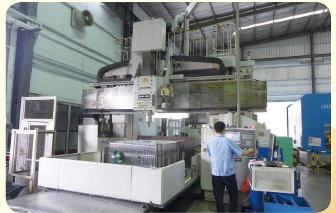
加工中心正進行大型模架加工
