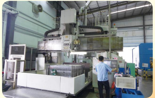
加工中心正進行大型模架加工
