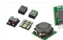
DC-DC converter module
