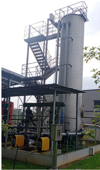
圖 3 本報告期，本公司永新縣工業開發區綜合污水處理廠項目增加了芬頓系統，提升了 COD 的去除率
