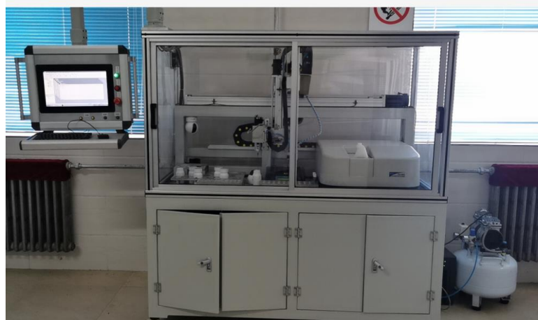
圖 8 污水處理項目使用實驗室機器人進行化驗工作
